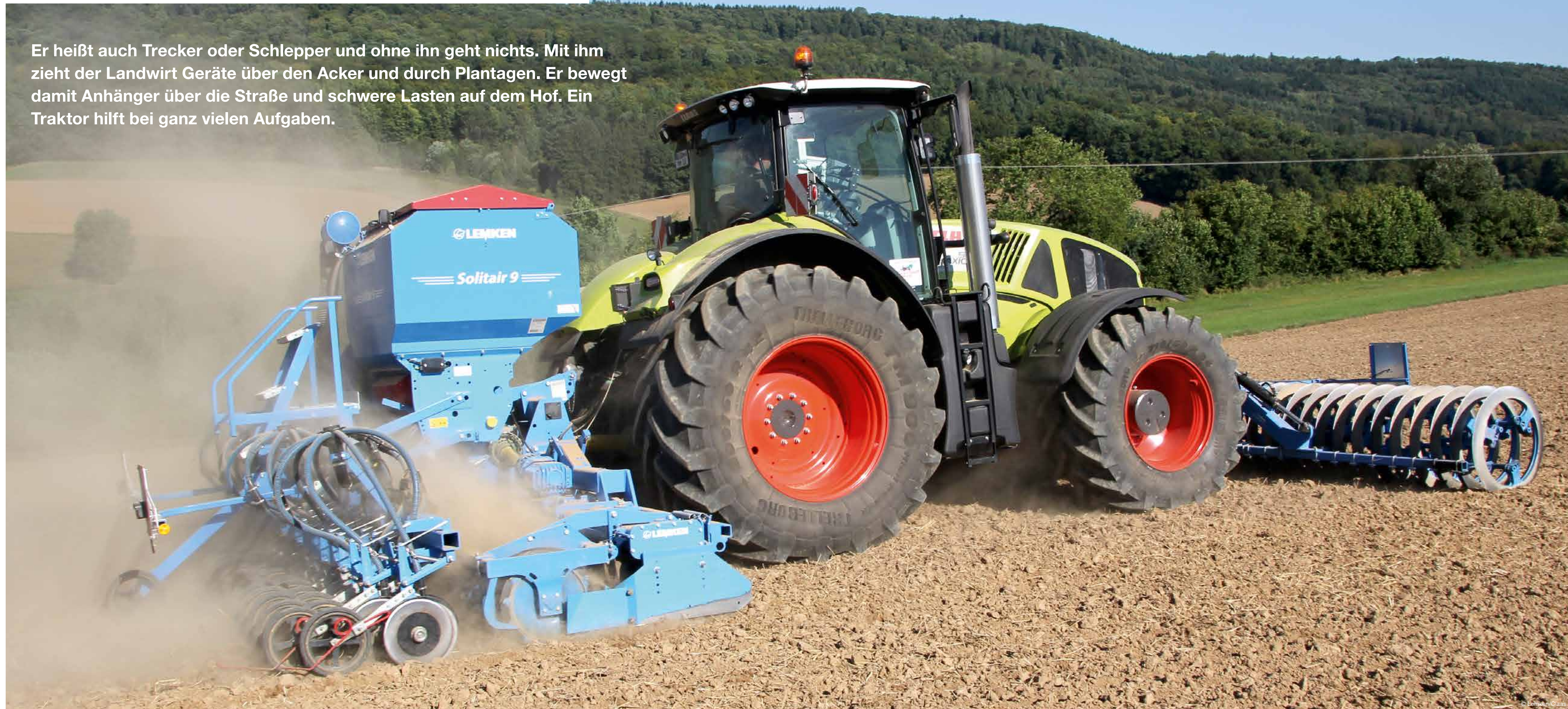
Traktor mit Kupplungen für Anbaugeräte an Front und Heck
