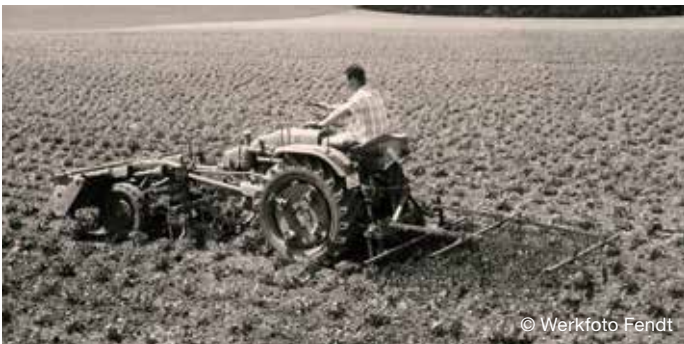
Traktor (Geräteträger) von ca. Ende der 1950er Jahre mit Netzegge hinten und weiteren Anbaugeräten
